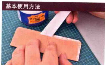
基本使用方法 用上胶片抽取白胶并使用。单面涂沫就可黏合，如果需要牢固黏合，可以将两面都涂上。
