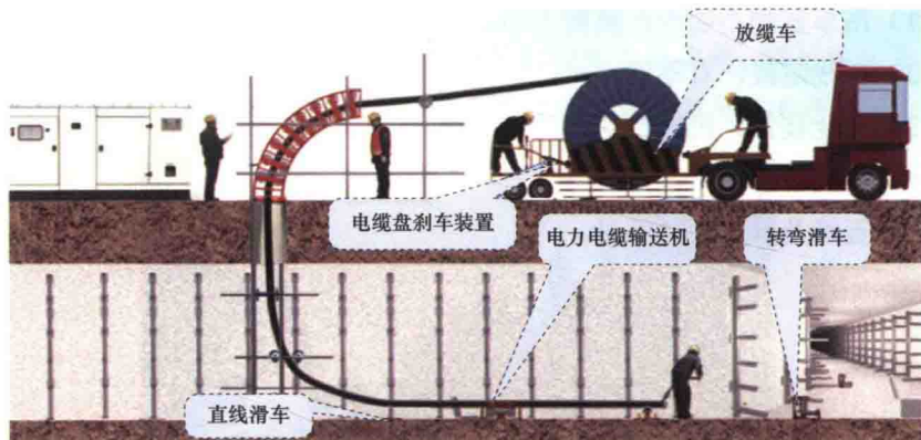
图 3-1 电力电缆敷设过程示意图
