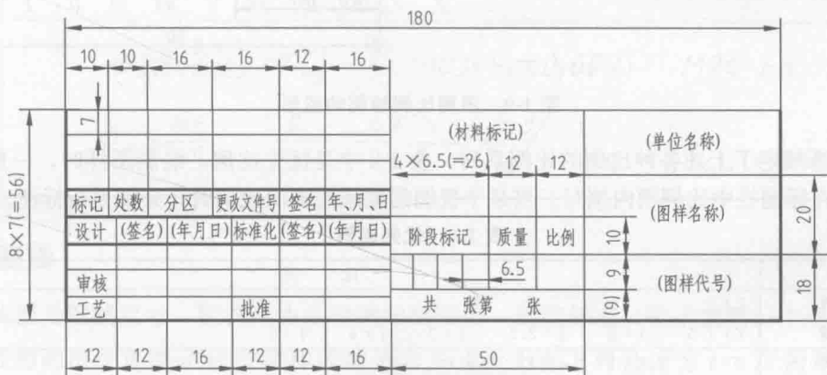
图 1-7 标题栏的格式和尺寸
