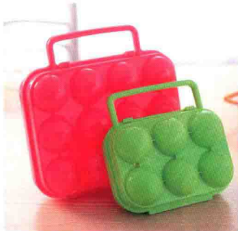
图1-2-4 鸡蛋盒带有提手，方便携带，提手造型是与塑料包装盒一体注塑成型的
