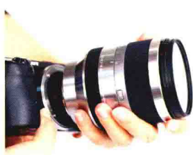
③ 旋转至两个白点重合时，即可顺利取下镜头
