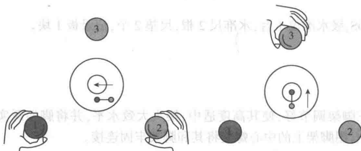
图 2-1-2 水准仪的粗平
