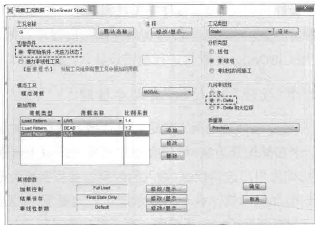
图 25-8 初始非线性重力工况定义
