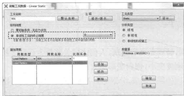
图 25-9 后续静力工况定义
