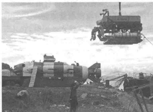
图 1-6 Super Scorpio ROV(右上)用于营救 AS-29 微型潜艇(左下)
