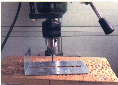
图1-2 用台钻在角铁上钻出两个电机的固定孔，用来穿过尼龙扎带固定电机。还要在车头部分钻出控制电路的安装孔
