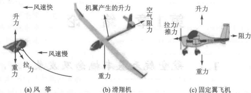
图 1.1 风筝、滑翔机和固定翼飞机的受力分析
