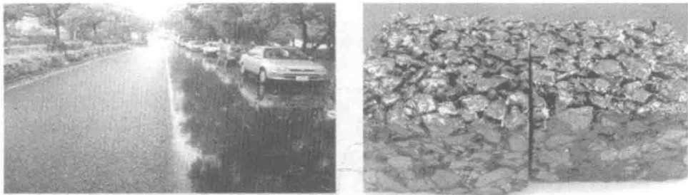
图 1.4 透水沥青路面及混合料试件
