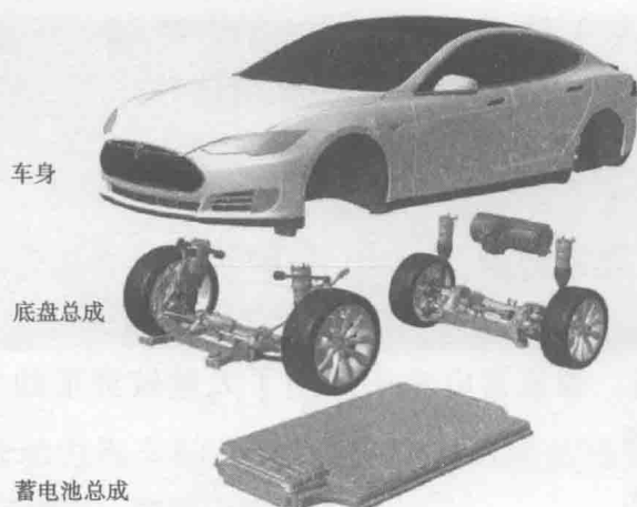
图 1-8 蓄电池安装位置
