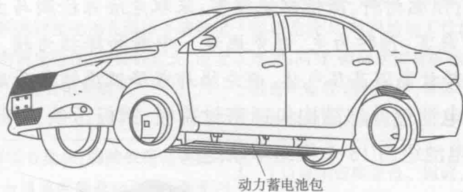
图 1-10 比亚迪 e5 动力蓄电池包安装位置
