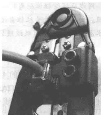
图 1-17 将 RJ-45 插头插入压线插槽
