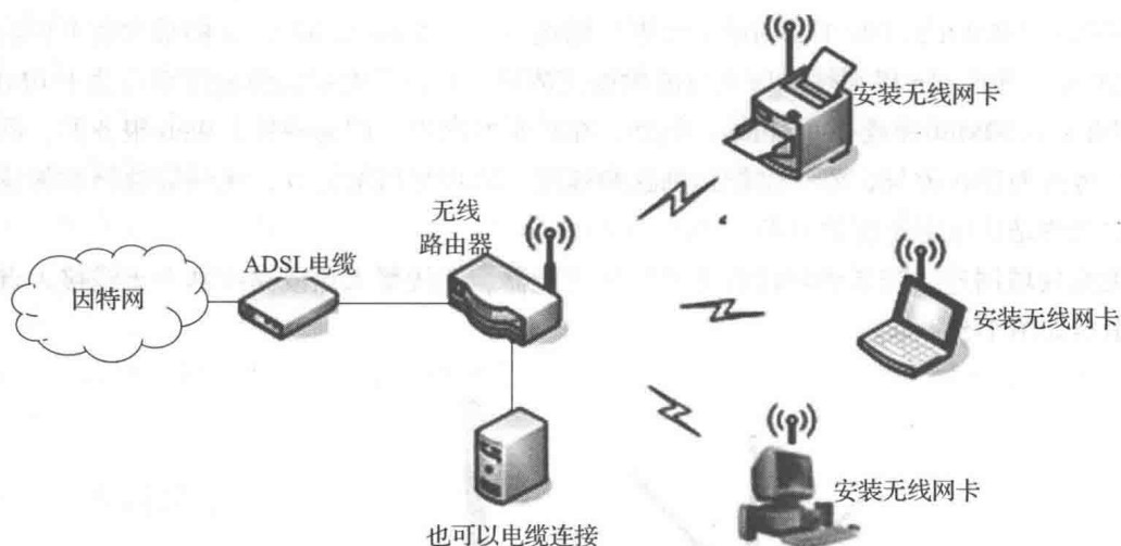
图 1-6 使用无线路由器连接网络
