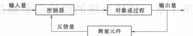
图 1.3 闭环控制系统的一般结构
