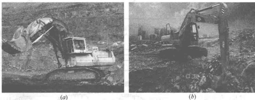
正铲挖掘机和反铲挖掘机对比图
