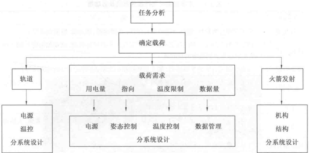
图 1.2 空间飞行器分系统设计流程图
