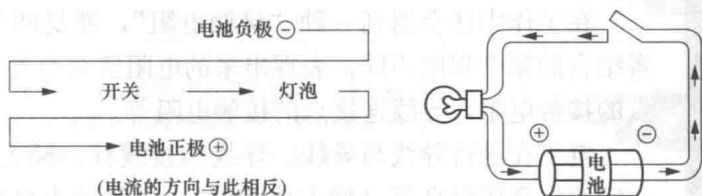
图 1-5 手电筒的工作过程
