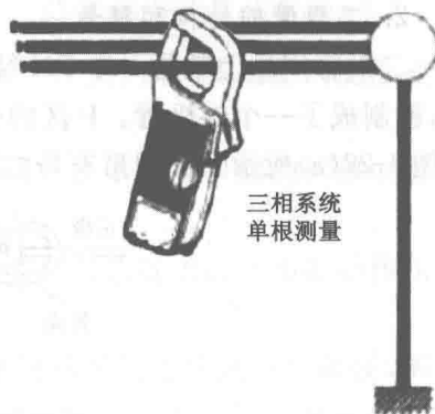
图 1-25 测量三相电系统示意图
