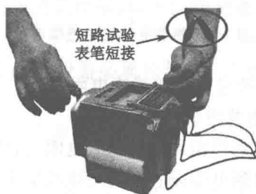
图 1-5 兆欧表的短路试验
