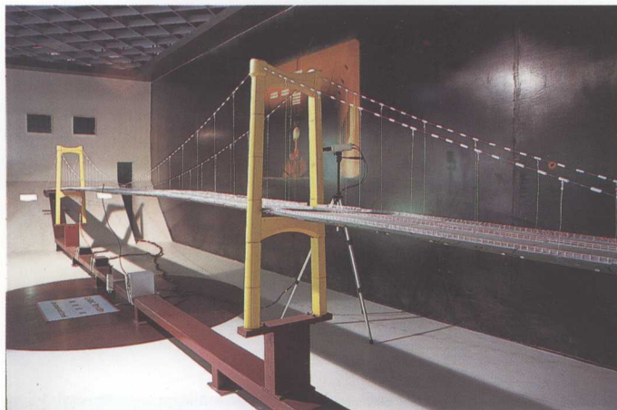
海沧大桥的低速风洞试验模型。
