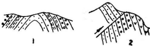
图 2—9 倾斜岩层可以是： 褶曲的一翼（1），断层的一盘（2）
