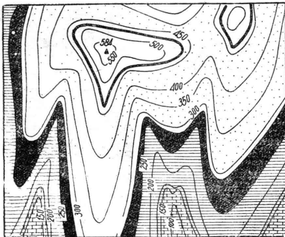
图 2—7 水平岩层的出露分布特征 上图：立体图； 下图：平面图 (地形地质图)
