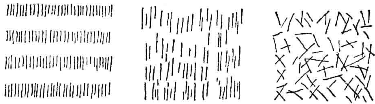
(a)晶体 (b)各向异性的向列液晶 (c)各向同性的液体
