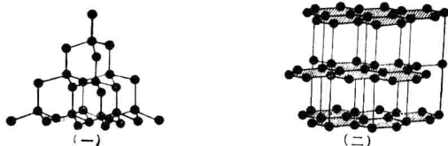
图5 金刚石(一)与石墨(二)结晶构造对比图
