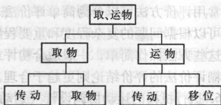
图 2-6 挖掘机的功能分解图
