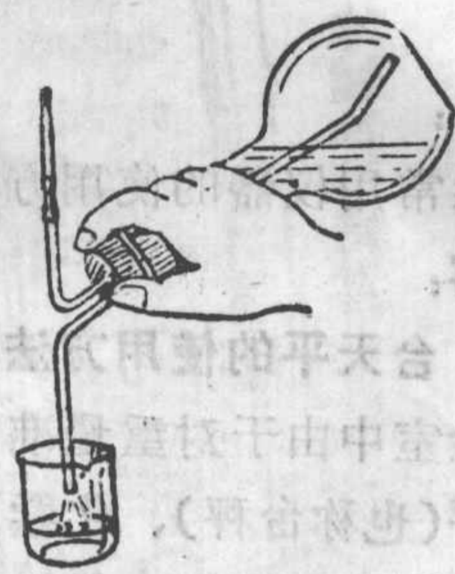
图4 洗瓶的用法(倒转)
