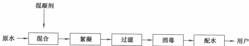
图 1-2-2 常温低浊水处理工艺
