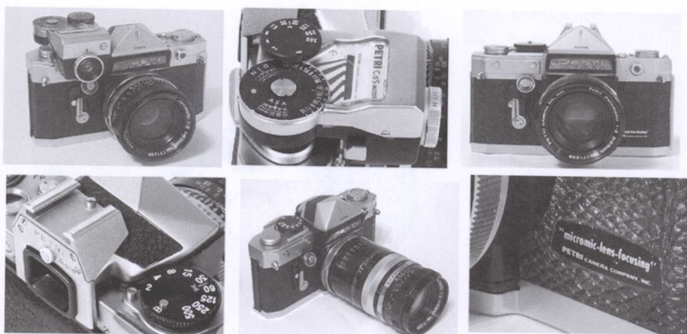
60年代应用了硫化镉测光表的单反相机
