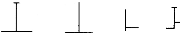
图 1-1-2 铝合金吊顶龙骨及零配件示意
