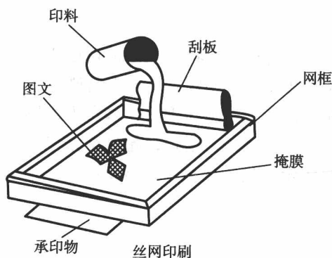
图 1-7 网版印刷原理示意图
