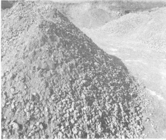
图 1-17 石子粒径不符合要求
