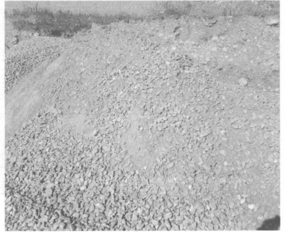
图 1-18 砂子含泥量大、粒径小
