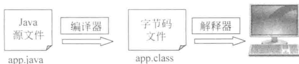
图 1.1 Java 程序的运行过程: 先编译,后解释
