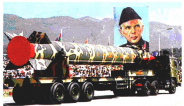
图 1.23 巴基斯坦“高里- II”(Ghauri- II)导弹射程为 2 300 km，有效载荷 1 000 kg
