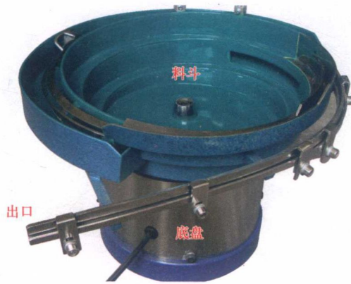
图 1-9 小型散料的标准供料设备——振动盘
