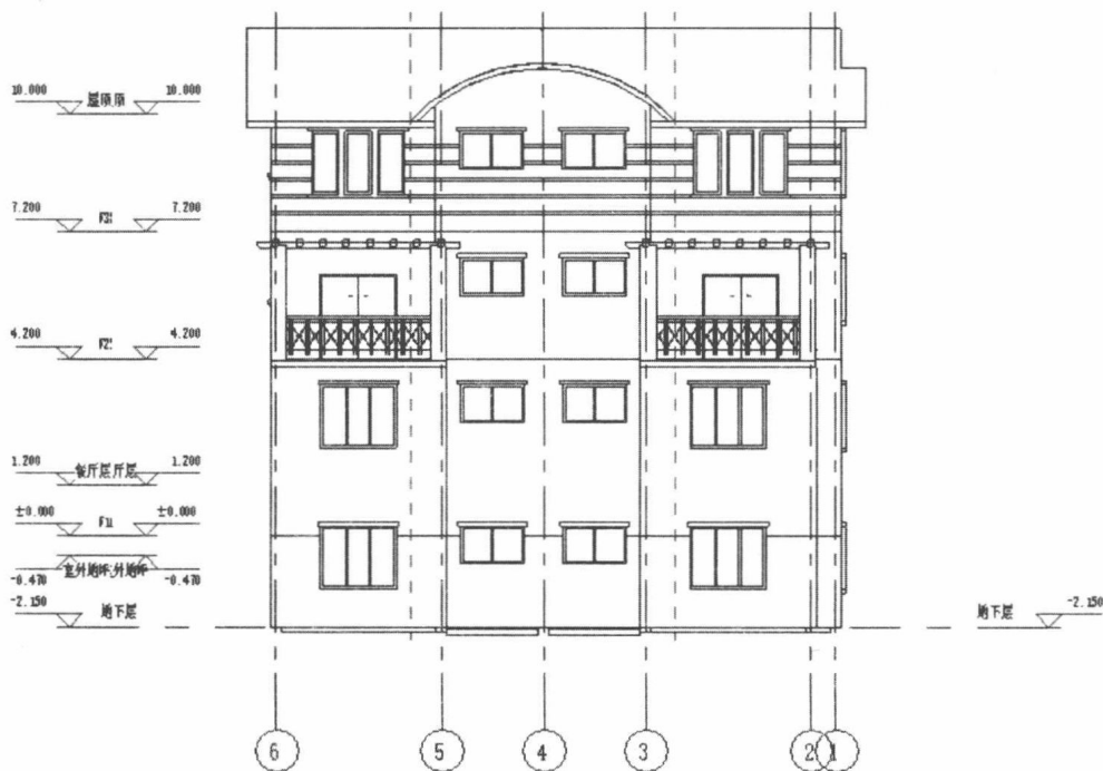
图 1-2 某别墅建筑的北立面图
