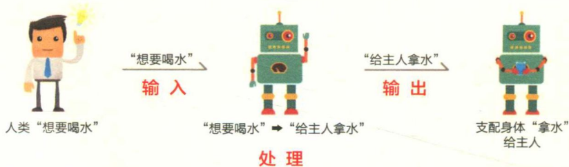
图 1.16 机器人“拿水”动作的产生
