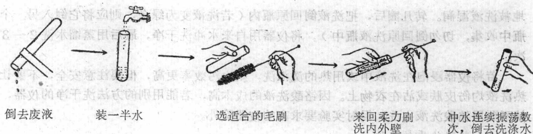
图1-1 洗涤试管的操作步骤示意图
