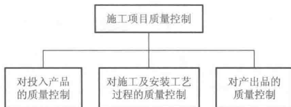
图 1.3 按照工作顺序划分的系统质量控制过程
