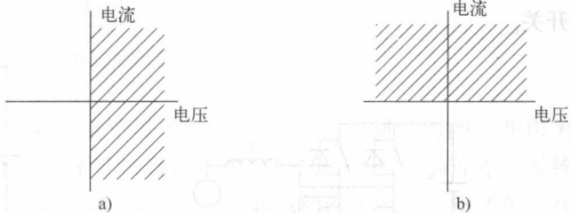
图 1-2 两种典型开关下的电压-电流平面 a) 电流双向开关 b) 电压双向开关
