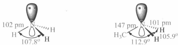
图 14-1 氨及甲胺的四面体结构示意图
