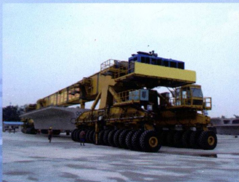
图 5.13 轮胎运架一体式架桥机
