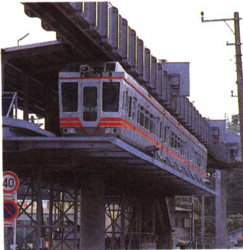
湘南モノレール。地域に根づいた路線として通勤客に欠かせない存在となっている。写真は駅に停車中のもので、乗客の落下防止のためのネットが張られている。サフェージュ式
