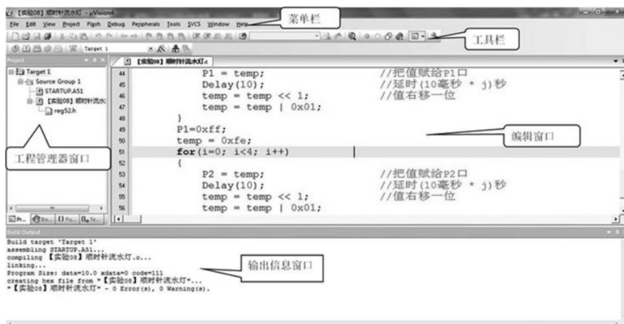
图 1.2.1 Keil \mu Vision4 软件编辑状态下的操作界面
