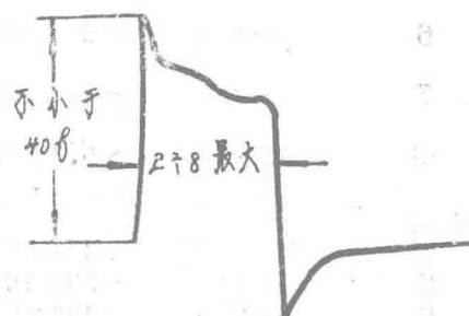
2.Г3—2插孔上相对于外壳的触发脉冲
