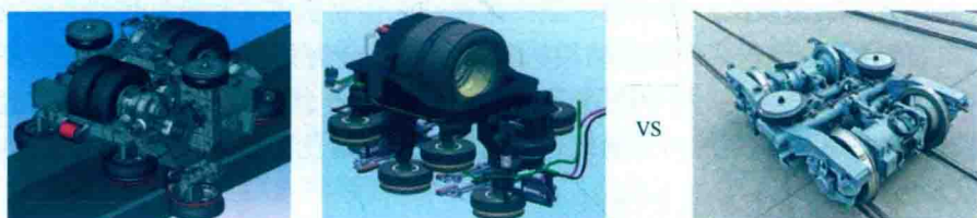
图 1-1-4 跨座式单轨车辆与普通钢轮钢轨车辆转向架对比图
