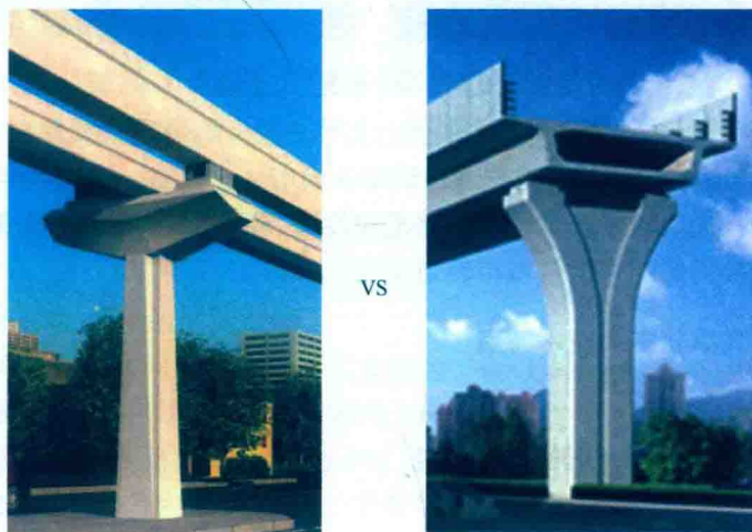
图 1-1-12 跨座式单轨系统与普通钢轮钢轨系统高架区间结构对比图
