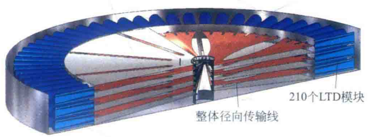
图 1.4 基于 LTD 模块的 Z 箍缩驱动器设计原理图
