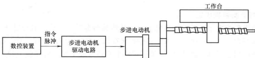
图 1-10 开环控制数控机床的原理
