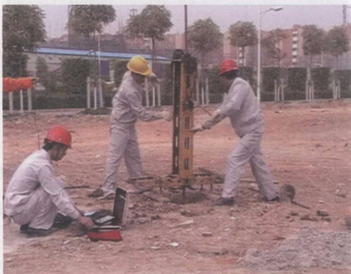
图 1-1-3 静力触探试验
