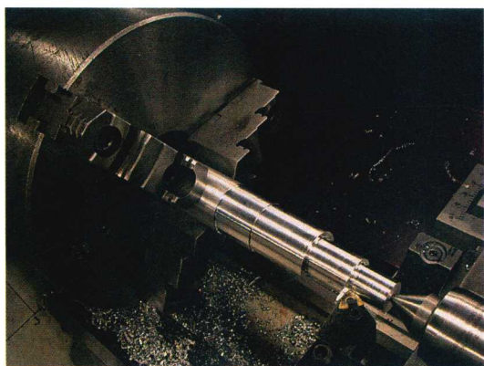
图 1-1 车床夹紧工件并使工件相对于刀具旋转以加工回转类零件。刀具移动方式决定了零件的回转面形状
