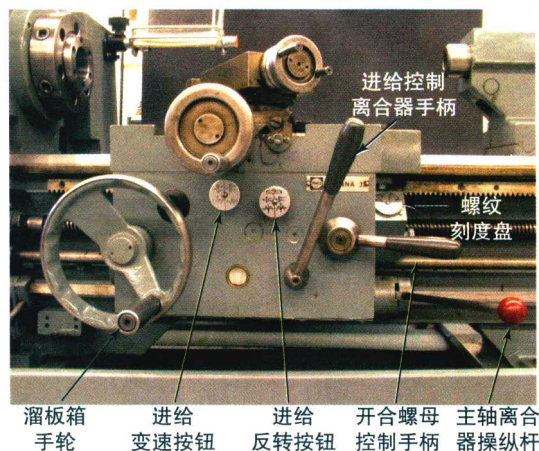
图 1-17 安装在溜板箱上的车床控制手柄（或按钮）
