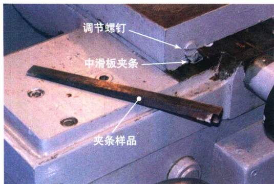
图 1-15 调节小滑板上的夹条，使燕尾导轨变紧来减小由磨损引起的松动
