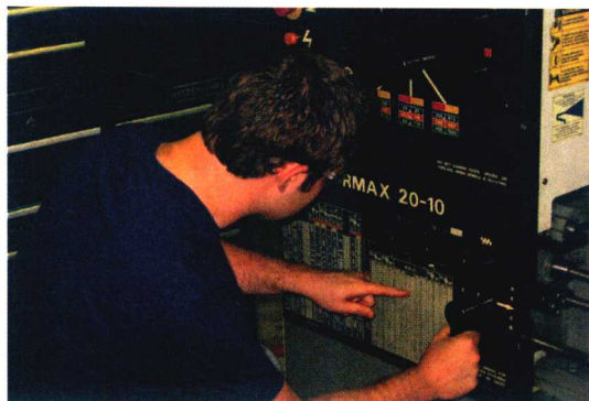
图1-10 通过改变变速箱上手柄的挡位来改变每转进给量
