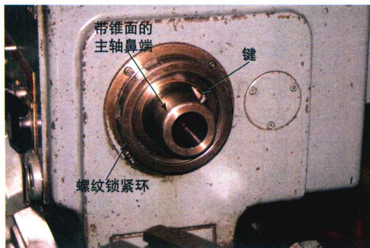
图1-6 带锥面的主轴鼻端，有时也称作“L-锥度”
