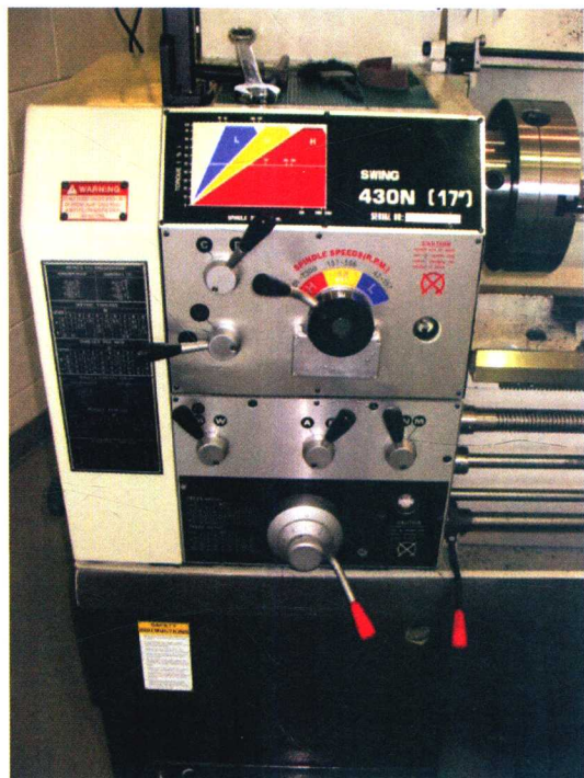
图 1-3 车床的主轴箱，包括主轴和用来给主轴和刀具运动传递动力的传动带或齿轮
