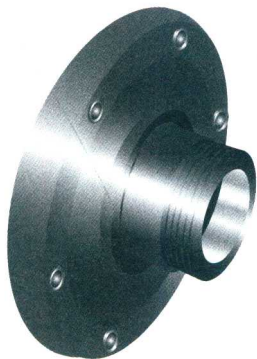
图1-5 带螺纹的主轴鼻端，在现在的车床上已不多见。千万不要在主轴通电旋转的情况下试图将夹紧装置安装到主轴鼻端的螺纹上，也不要握住夹盘。一定要在主轴停下来后手动旋紧螺纹
