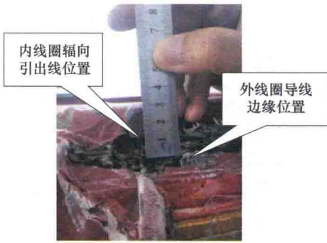
图 2-4 绕组线圈绝缘击穿部位
