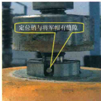
图3-3 定位销与将军帽不接触
