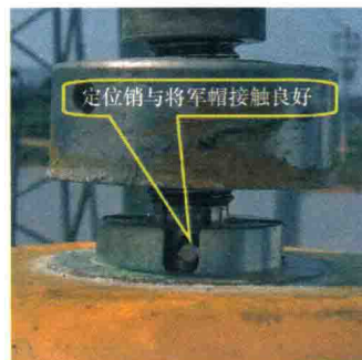
图3-4 定位销与将军帽接触良好
