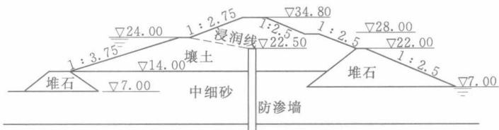
图 1.1 土石坝防渗墙防渗示意图
