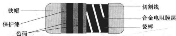
图 2-3 MELF 电阻器结构
